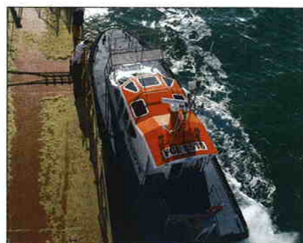
L'Arméria 2007 est une pilotine rapide en aluminium et à hydrojets
